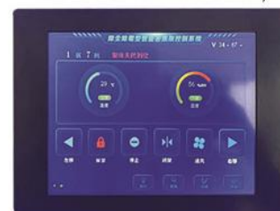
控制列彩色液晶触摸大屏 (10.4寸/12.1寸/15寸)
